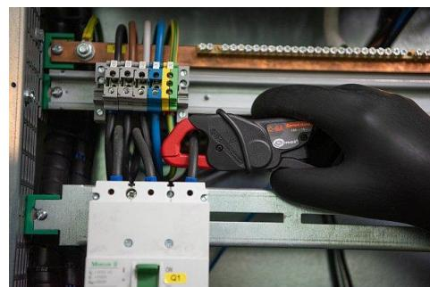
El hueco (formado de las superficies del núcleo) debe mantenerse perfectamente limpio.
